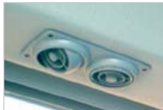
Air conditioner louver (BH090)
